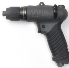
Pour petites et moyennes séries couple réglable par bague externe crantée embrayage à clabot visualisation des puissances par fenêtre carter composite léger et isolant poignée ergonomique inverseur droitier-gaucher échappement directionnel sur silencieux anneaux d'accrochage entrées d'air multiples adaptées au poste de travail capacité M3-M5.
