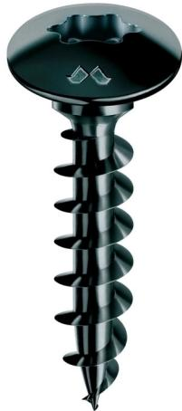
Vis Panelvit-FC tête bombée large (pour un meilleur serrage) empreinte Torx TX à Filetage Total. Revêtement noir NEROPLUS avec traitement anti-griffures. Vis indiquée pour la fixation de charnières et pentures sur menuiseries bois et PVC.
