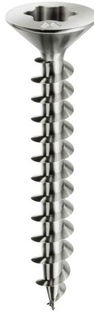
Vis Panelvit Filetage Total empreinte Torx TX, à revêtement Chromiting (résistance à la corrosion 5 fois supérieure au zingage blanc standard - Grade 4 de la norme NF EN 1670). Vis universelle lubrifiée indiquée pour le vissage sans pré-perçage dans : panneaux agglomérés mélaminés, bois, éléments de quincaillerie, tôles fines, matières plastiques et chevilles.
