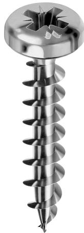
Vis à bois Panelvit tête ronde empreinte cruciforme (PZ) à Filetage Total. Traitement galvanique Chromiting qui protège la vis contre la corrosion et la rouille dans le temps (résistance à la corrosion en brouillard salin > 240h - Grade 4 norme NF EN 1670).
