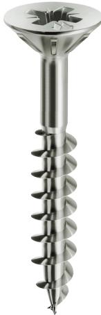
Vis Panelvit Tête Fraisée Partiellement Filetée empreinte cruciforme (PZ) - Traitement anticorrosion Chromiting (résistance à la corrosion 5 fois supérieure au zingage blanc). Vis conseillée pour fixer ensemble des éléments de grande épaisseur sans prépercer les parties à assembler.
