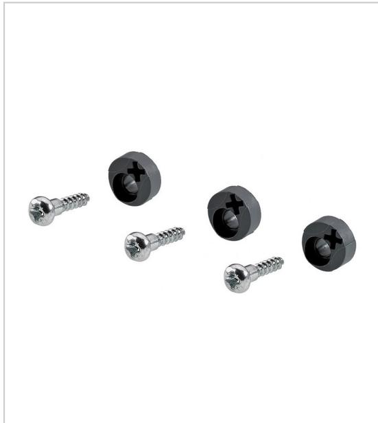
Set de rondelles excentriques permettant de régler les façades des tiroirs Systema Top 2000 en 3 dimensions et de fixer avec les vis fournies.
