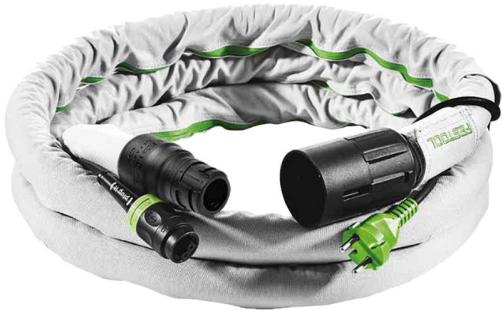
Pour tous les outils électroportatifs avec raccord Ø 27 et Ø 36 (tous les outils électroportatifs Festool) et accessoires de nettoyage ; avec connexion plug it; antistatique; particulièrement approprié pour le ponçage; avec raccord tournant et manchon de raccordement à baïonnette; résistant à la température jusqu'à + 70 °C; lisse
