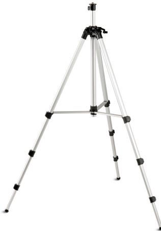
Tête de trépied rotative 89 - 295 cm (avec colonne centrale de 120 cm long) 2,9 kg trépied à colonne léger en aluminium filetage 5/8" plage de travail très large de 1 m à 3 m. double colonne : de 54 cm à manivelle et 59 cm coulissante poignée de transport nivelle sphérique intégrée sacoche de transport compris.
