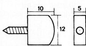
Taquet laiton avec vis double filet acier.
