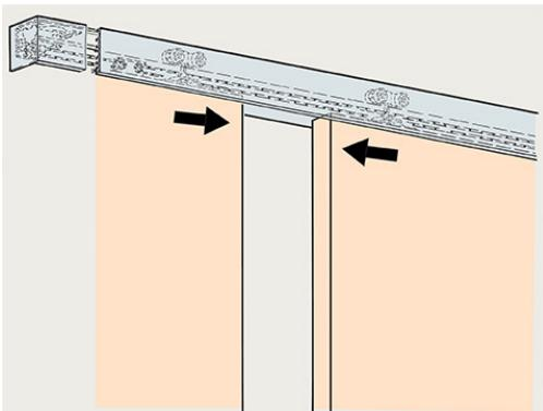
Mécanisme complémentaire qui permet l'ouverture ou la fermeture synchronisée de 2 portes posées sur le même rail simple.
