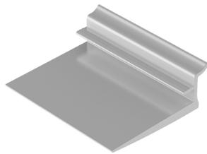
Fixation de la tablette par queue de sapin sur le chant de la tablette.
