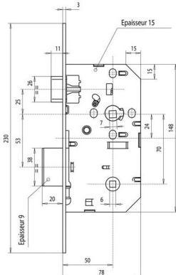
Serrure de sûreté à pênes dormant et 1/2 tour pour cylindre profilé (cylindre et gâche à commander séparément)
