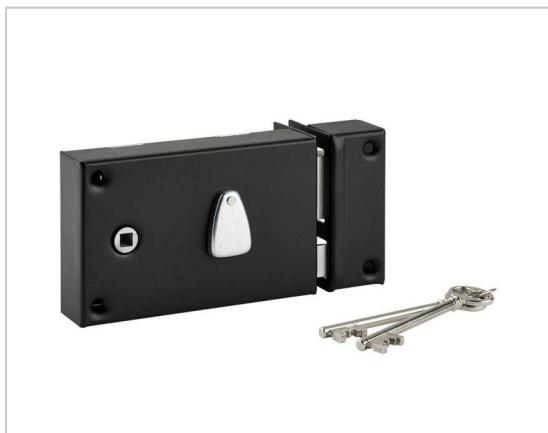
Coffre et gâche acier cambré époxy noir granitépêne et demi-tour aciercanon alliage longueur 45 mmm écanisme à 6 gorges 2 tours avec tirage ou à fouillote ntrée de clé acierà tirage : rappel du demi-tour par la clé livrée avec 2 clés nickelées (20 variures) garantie 10 ans.
