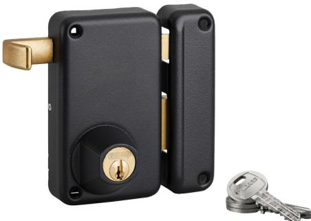
Serrure de sûreté finition époxy à tirage, avec double cylindre laiton 5 goupilles Ø23 mm x longueur 45mm.
