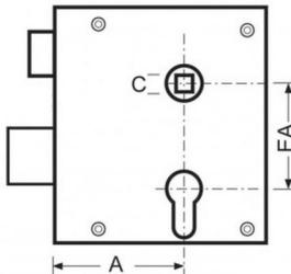
Serrure à cylindre en applique (coffre apparent) clé I (PZ) coffre épais zingué
