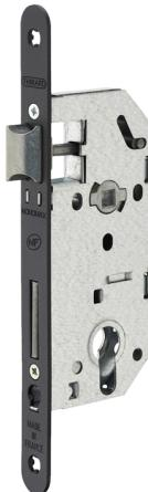
Coffre acier embouti galvanisé tête acier bouts ronds époxy noir granité demi-tour bi-pente alliage réversible sans démontage du coffre pêne acier galvanisé mécanisme à 2 tours pour menuiserie bois dimensions tête (L x l x é) : 230 x 20 x 2.5mm livré sans gâche (références fabricant : 046102 ou 046100 pour bec de canne) garantie 10 ans.
