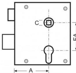
Serrure magnétique réversible pour portes à recouvrement et portes à fleur - pour portes intérieures et portes palières avec pêne demi-tour magnétique , pêne dormant nickelé poli et coffre zingué
