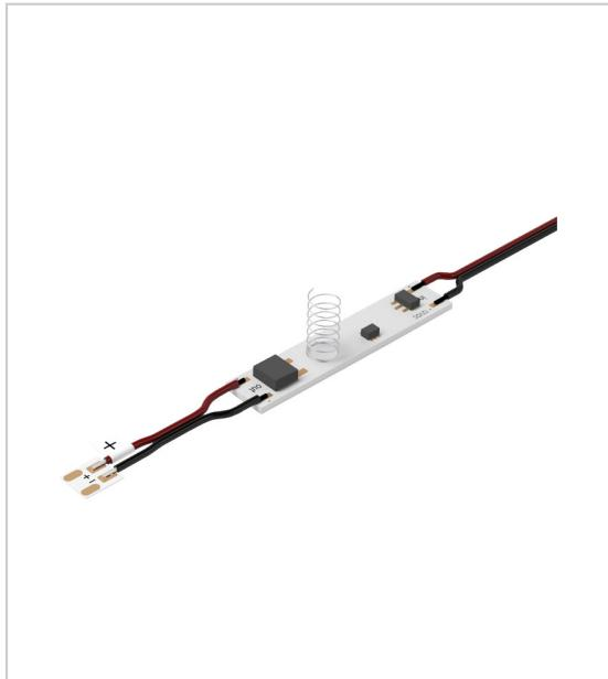
Interrupteur variateur à intégrer dans le profil aluminium.
