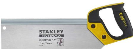
Idéal pour les travaux de finition denture JetCut 11 dents/pouce et denture universelle 13 dents/pouce traitement de denture HardPoint 2x avec avoyage alterné lame de 0,86 mm d'épaisseur pour plus précision de coupe dos renforcé pour plus de contrôle lors du sciage poignée bi-matière ergonomique fabrication française.
