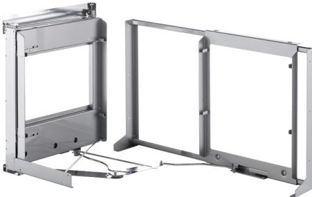
L'ouverture de la porte entraîne l'extraction du cadre pivotant, faisant ainsi coulisser face à l'ouverture, la partie de la ferrure située dans l'angle mort du meuble.
