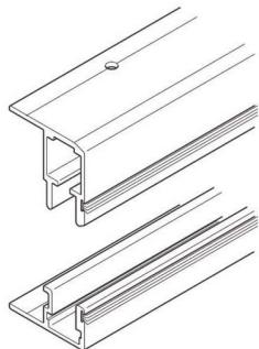
Rails de roulement et de guidage pour Multifold 30.
