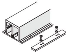
Profil de renforcement avec plaque de raccordement pour rail de roulement Folding Concepta.
