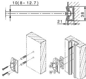
Raccordement optimal au mur pour portes tout-verre coulissantes avec chant de verre non protégé.
