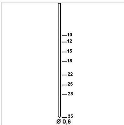
Pointes de finition minibrads 18 mm, diamètre 0.6mm
