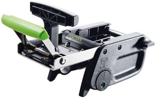
Fonction de coupe de joints pour panneaux ronds et de coupe de chants pour plateau (sciage final) avec un seul outil|pour couper des chants en plastique d'une hauteur de 18 - 65 mm ainsi qu'une épaisseur de chants de 0,5 - 2,0 mm (en fonction du matériau)
