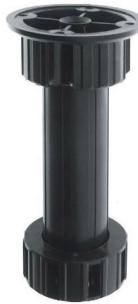
Pied ABS noir Ø 28mm avec vérin et embase de fixation non démontable à 4 trous de vis.
