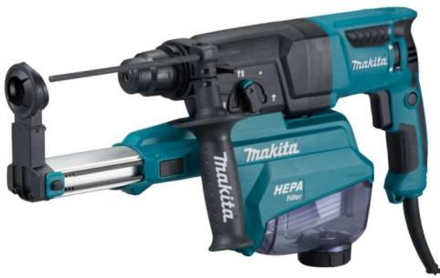
Puissant moteur de 800 W, délivre 2,2 J d'énergie d'impact pour traiter les applications les plus exigeantes. Le limiteur de couple arrête la rotation en cas de blocage pour une sécurité de l'opérateur et du moteur. 3 modes Perçage, Perforation ou Burinage pour plusieurs applications
