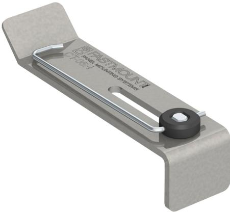
L'outil CT-05H permet de démonter les panneaux assemblés avec les clips Fasmount. Son crochet 1/4 de tour permet notamment la dépose de panneaux avec petits joints creux entre eux.
