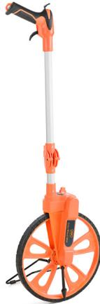
Poignée pistolet avec gomme antiglisse, pour plus de confort à l'utilisation mise à zéro et frein d'arrêt intégrés dans la poignée mesure minimale 10 cm le mécanisme de dénombrement (compteur) fonctionne en avant et en arrière large béquille en métal stable et rétractable pliable pour le transport, équipée d'un bouton de blocage fourni avec sac de transport.
