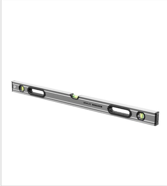
Corps tubulaire aluminium renforcé haute résistance précision : +/- 0,5 mm/m 3 fioles indéréglables haute visibilité : 1 horizontale et 2 verticales semelle usinée des deux côtés revêtement protecteur anti-abrasion embouts de protection renforcés poignée bi-matière vissée.
