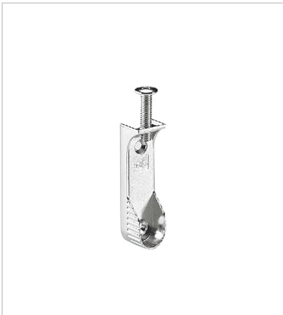
Naissance pour tube ovale 30x15 mm, à visser sous la tablette avec vis spéciale M6 x 25 ou fixation latérale EA-42 mm.
