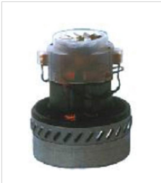
Moteur by-pass périphérique 2 étages en 143 mm de diamètre. Ce moteur est refroidi par une ailette dédiée afin de le protéger des remontées d'humidité qui pourraient le griller. L'air aspiré est refoulé sur la périphérie par les ouies.
