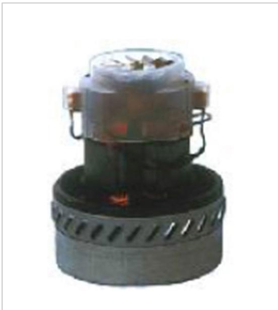
Moteur by-pass périphérique 2 étages en 143 mm de diamètre. Ce moteur est refroidi par une ailette dédiée afin de le protéger des remontées d'humidité qui pourraient le griller.
