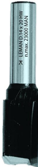
2 coupes latérales avec coupe frontale, pour une meilleure pénétration lors des plongées en plein bois permet de réaliser des assemblages rainure et languette mèches droites inférieures à 7 mm en carbure monobloc pour éviter leur casse, compte tenu de leur faible diamètre.
