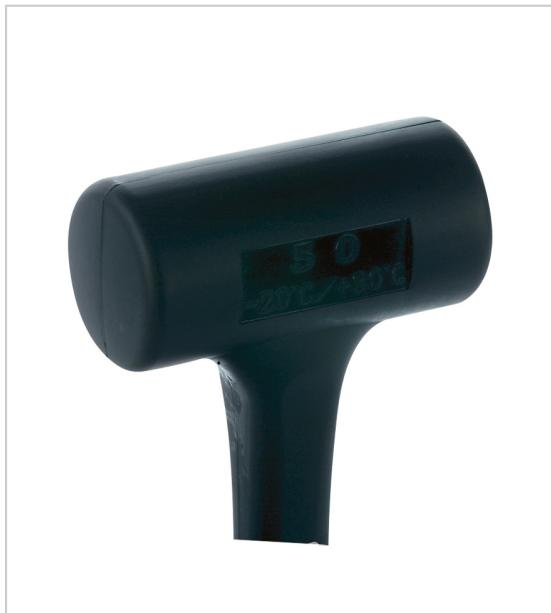
Effet sans rebond, tête partiellement remplie de billes d'acier. effet d'inertie lors de la frappe. dureté faible : A86 (limite le risque d'éclat des pièces métalliques frappées). surmoulage intégral : NBR Nitrile Rubber, résistant de -20°C à +90°C (évite la rupture de la tête et l'échappement des billes). utilisation : montage, assemblage, positionnement de pièces, idéal pour les phases d'ajustage précis.
