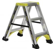
Larges et solides profils aluminium au design ergonomique 2 sangles de sécurité anti-écartement (2x3 et 2x4 marches) compas anti-écartement (2x5 marches) articulations anti pince-doigts marches antidérapantes de 80 mm soudées sur de larges profils aluminium patins extra larges antidérapants.
