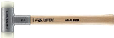
Le tube de tête des marteaux SUPERCRAFT est rempli de grenaille d'acier. Ainsi, lorsque l'embout frappe une pièce, la garniture de grenaille suit en décalé. La réduction du rebond optimise la force de frappe. Par conséquent, des frappes très puissantes sont possibles. De plus, l'utilisation des marteaux SUPERCRAFT est nettement plus sûre, elle protège et soulage les articulations et réduit le bruit par rapport aux marteaux classiques.
