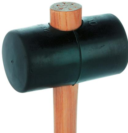
Permet de ne pas abîmer le matériau ou l'assemblage lors de la frappe usage : montage de meuble, parquet... tête en caoutchouc dure 85 +/- 5 Shore Atête légèrement bombé manche à emmanchement conique.
