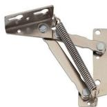
Compas de relevage Lift junior 90 Cette ferrure très discrète et compacte ne nuit en rien au design du meuble. - Effet de ressort 90 N - Angle d'ouverture 75° - Poids maxi. de l'abattant 2 kg - Montage rationnel par fixation sur perçages en série - Compas de relevage disponible uniquement, en jeu complet comprenant une ferrure gauche et une ferrure droite.
