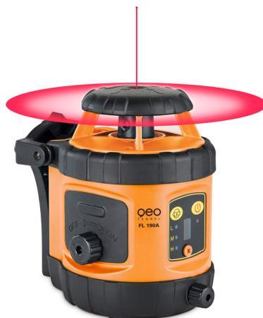
Laser automatique à l'horizontale, manuel à la verticale facile à régler grâce à une seule molette auto-nivellement très rapide 3 vitesses de rotation filetage : 5/8" précision : 'b1 1,5 mm / 10 m autonomie : 20 h étanchéité : IP 54 poids : 1,5 kg fourni avec cellule de réception FR45, pack accu NIMH, chargeur et sacoche.
