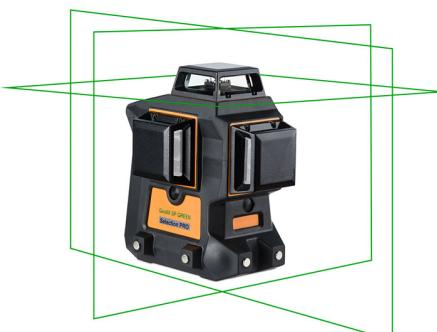
3 lignes à 360° simultanées - 6 croix laser précision : 'b1 2 mm / 10 m diode : verte visibilité des lignes : 60 m (rouge) - 80 m (vert) portée du faisceau (rayon) : Ø 80 m portée avec cellule (rayon) : Ø 140 m alimentation : batterie Li-Ion autonomie : 14h indice de protection : IP 54 livré en coffret rigide avec support multi-fonctions, cible magnétique, batterie, chargeur et câble USB3 3.0, bloc de piles de secours.
