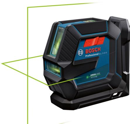
Lignes laser horizontales et verticales mise à niveau automatique jusqu'à 14° filetage du trépied: 1/4, 5/8 protection IP64 livré avec support universel LB 10, platine de mesure laser, poche et 4 piles 1,5 V LR6.
