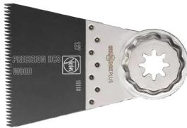
Denture japonaise double pour tous les matériaux dérivés du bois, les plaques de plâtre et les plastiques souples. Vitesse de travail extrêmement élevée et précision optimale. Forme extra-large pour puissance maximale de coupe et coupes longues et droites.
