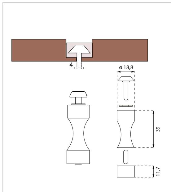
Supports pour couteaux à fixer sur le profil mural titanium ou aluminium PIN.
