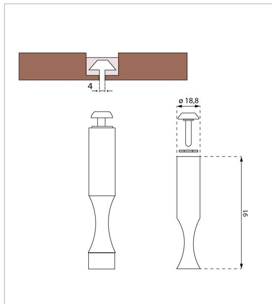
Support pour bouteille à fixer sur le profil mural titanium ou aluminium PIN.
