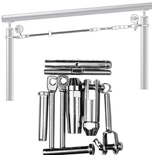
Pour montage de câble orientable entre deux tubes ronds.
