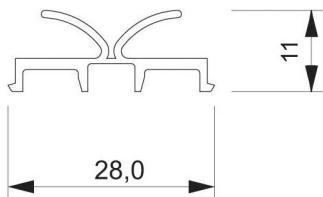
Réduit les chocs à la fermeture et rend étanche à la poussière. Zone tampon optimale entre le verre et le métal.
