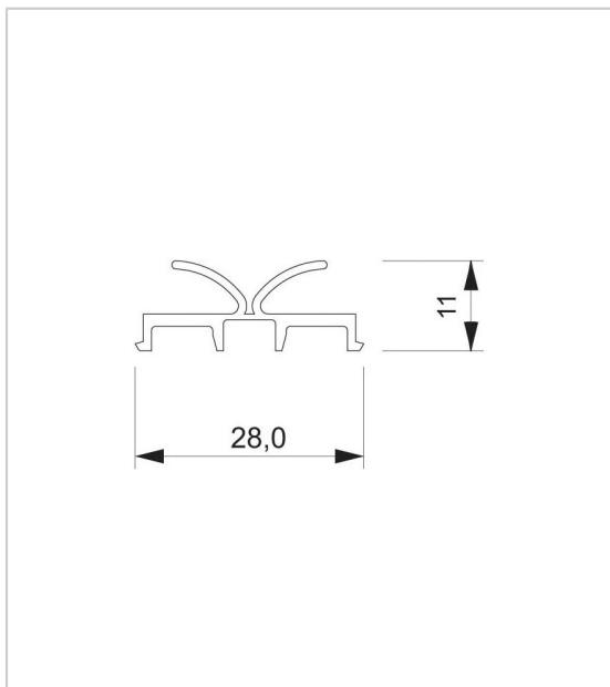
Réduit les chocs à la fermeture et rend étanche à la poussière. Zone tampon optimale entre le verre et le métal.
