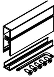
Profil pour glace fixe, avec profil de recouvrement et vis spéciales à tête fraisée 5,5 x 19 mm.
