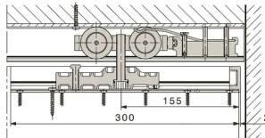
HAWA-Junior 120 B, pour portes pesant jusqu'à 120kg par vantail, est équipée de suspension à profils porteurs permettant une hauteur minimale d'installation.
